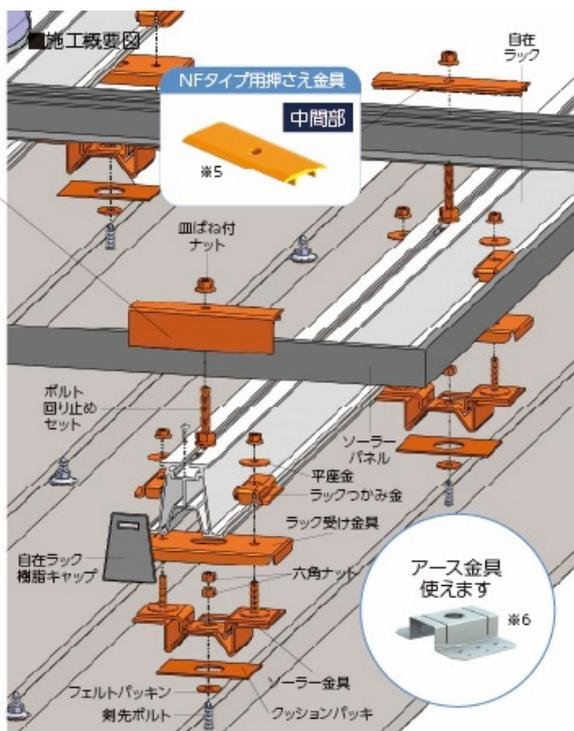
※血ばね付ナットは3点セット（平座金・ばね座金・六角ナット）の場合があります。
