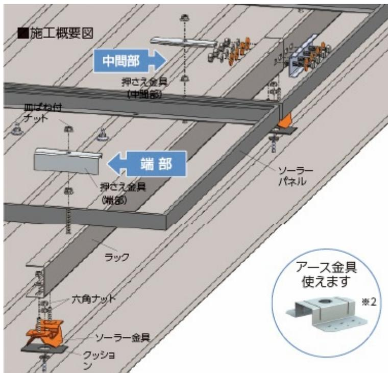
※血ばね付ナットは3点セット（平座金・ばね座金・六角ナット）の場合があります。
